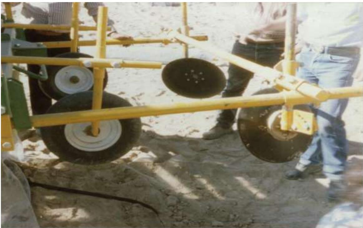
Figura 1. Maquina utilizada para el acolchado de suelos agrícolas.
