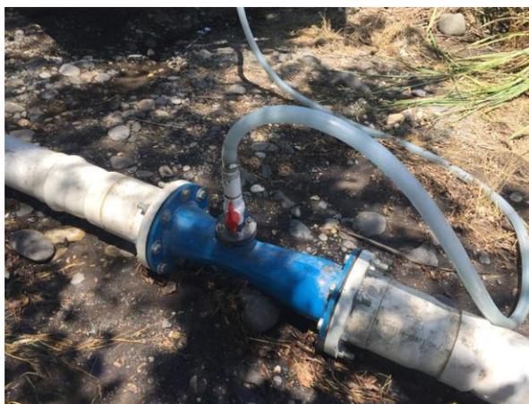
Figura 1. Prueba en campo de inyector de fertilizante tipo Venturi, acoplado a un sistema de fertirriego de baja presión.
