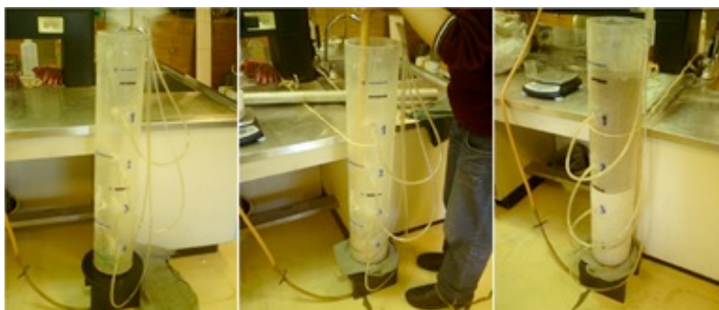
Figura 2. Ensamble y llenado de la columna.
