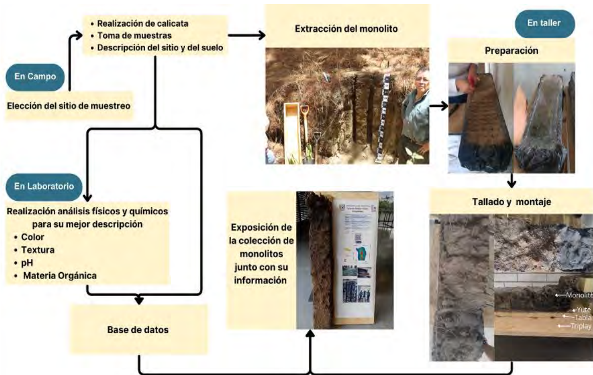
Figura 2. Diagrama de flujo que muestra los pasos a seguir para la fabricación de un monolito desde su extracción, preservación y montaje.
